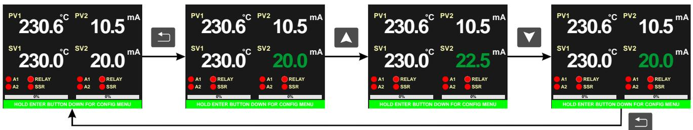
Wenn die Zurück-Taste gedrückt wird, leuchtet die SV2 LED grün. Durch Drücken der Tasten Auf / Ab wird der SV1 Wert eingestellt. Mit erneutem Betätigen der Set-Taste oder 3 Sekunden warten, wird der Wert gespeichert und die Farbe der SV1 LED wird wieder weiß.
