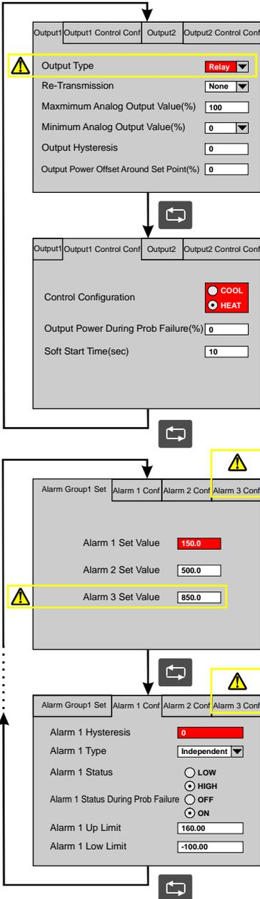
**Ausgangstyp (>Output Type<):** Kann als Relais (Relay), SSR, 0-20mA, 4-20mA oder 0-10V ausgewählt werden. Wenn das Relais nicht als Ausgang ausgewählt ist, kann dieser zusätzlich als Alarm 3 verwendet werden.
