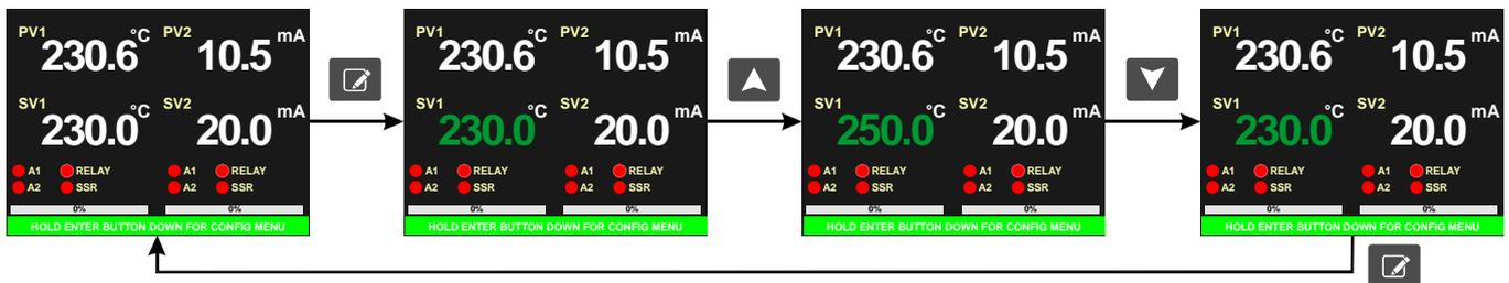
Wenn die Set-Taste einmal gedrückt wird, leuchtet die SV1 LED grün. Durch Drücken der Tasten Auf / Ab wird der SV1 Wert eingestellt. Mit erneutem Betätigen der Set-Taste oder 3 Sekunden warten, wird der Wert gespeichert und die Farbe der SV1 LED wird wieder weiß.
