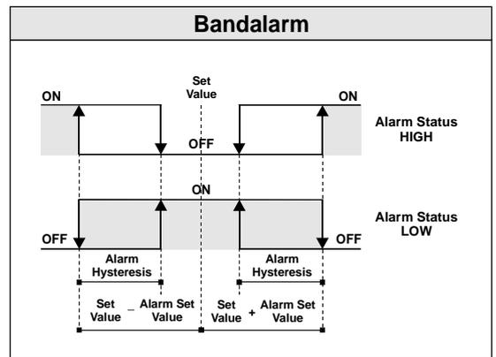
Bandalarm mit Unterdrückung (nach dem Einschalten)
