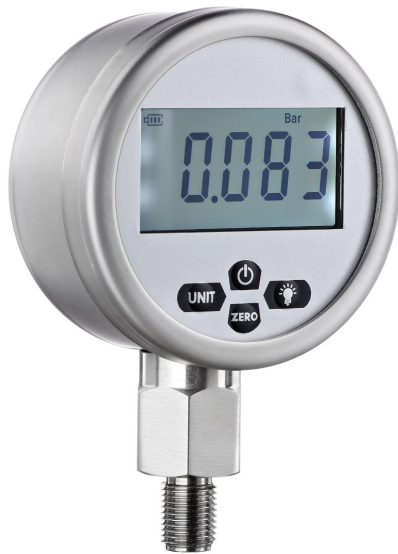
Batteriebetriebenes Digitalmanometer; Genauigkeitsklasse 0,4%; G1/4"
